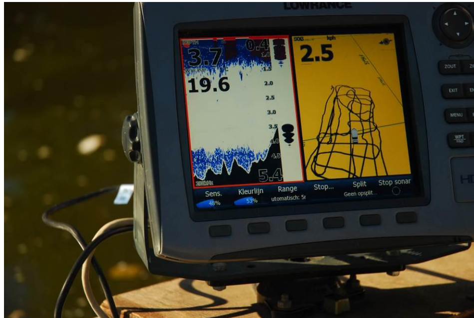
Figuur 2.2 De fishfinder met links het sonarscherm met diepteverloop (3,7 m is de actuele diepte, 19,6 is de watertemperatuur) en op het rechterscherm de afgelegde weg op het water (2,5 is de actuele vaarsnelheid in km/h).
